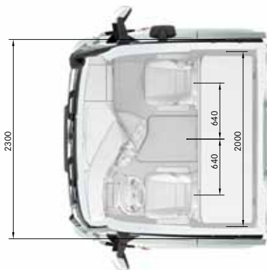
L-cab Exterior width 2300 mm
