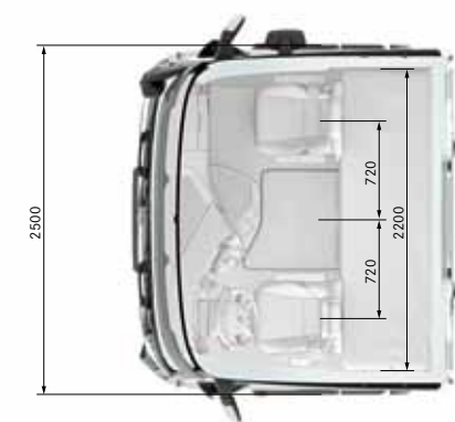
L-cab exterior width 2500 mm
